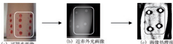
図1. シールの間にある見えない静脈を可視化した近赤外画像
